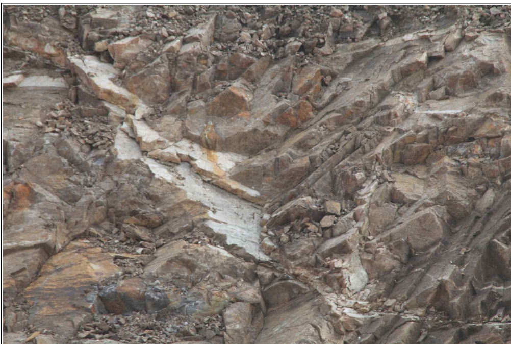
【그림 16】 B 영역에 발달한 불연속면 (깨기파괴 양상)
